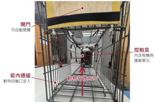
相機與運算單元裝在籠體末端的控制盒內；辨識與判定全部在裝置上完成。
