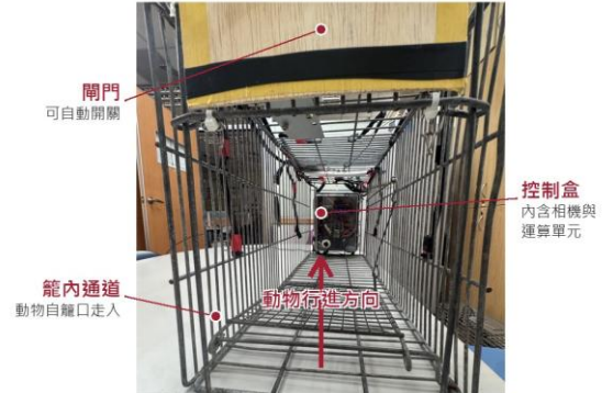
相機與運算單元裝在籠體末端的控制盒內；辨識與判定全部在裝置上完成。
